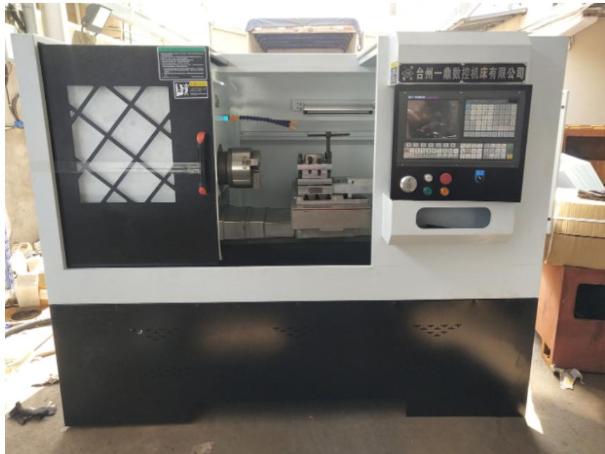
线轨数控机床可实现一机多用，节省厂房面积和建厂投资。因此使用线轨数控机床可获得良好的经济效益。线轨数控机床是一种新型数控加工机床，它的诞生，弥补了通用线轨数控机床（铣床、钻床等）加工功能单一，而加工中心加工小型产品成本过高的不足，为我国制造业的发展提供了一种性价比很高的新型机床产品，是我国机床工业中的新军。线轨数控机床的智能控制对数控系统提出了更高的要求，这需要数控系统不仅具有开放性、包容性和二次开发特性，还要根据用户对其功能个性化的需求，对数控系统接口的普适性和前瞻性也提出了较高的期望。环境温度线轨数控机床的环境温度应低于30摄氏度，相对湿度小于80%。数控线轨机床型号参数
