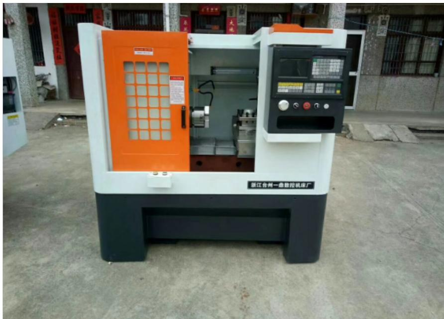
驱动装置是线轨数控机床执行机构的驱动部分，包括主轴驱动单元、进给单元、主轴电机和进给电机。他通过电液伺服系统在数控装置的控制下实现主轴和进给驱动。当多个进给联动时，可完成定位、直线、平面曲线和空间曲线处理。一种辅助装置，为保证线轨数控机床的运行，如冷却、去屑、润滑、照明、监控等，是指数控制机的一个组成部分。它包括液压和气动装置、去屑装置、开关台、数控转盘和数控分度头。编程等辅助设备，可用于编译和存储机外零件。线轨数控机床不同于普通机床，它是一种通过液压系统或数控系统驱动控制，采用气动系统来完成自动上下料。数控线轨机床型号参数线轨机床有效提高机床的切削精度及机床性能的稳定。
